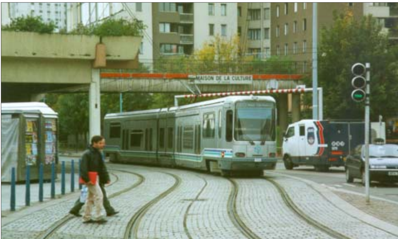
Figur 3.2 Spårvagnar är stadens mest effektiva fordon när det gäller att utnyttja gaturummet. Bussar kräver en till två meter bredare stråk. Foto från Paris 1998.
