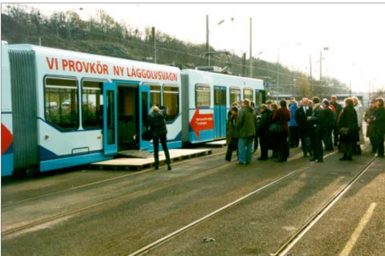
Figur 9.3 Den förnyade spårvagnen av typ M31 i Göteborg har försetts med en rymlig mellandel av låggolvsutförande.
